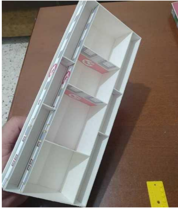
Figure 13 : assemblage les parois de la maquette d'architecture_
