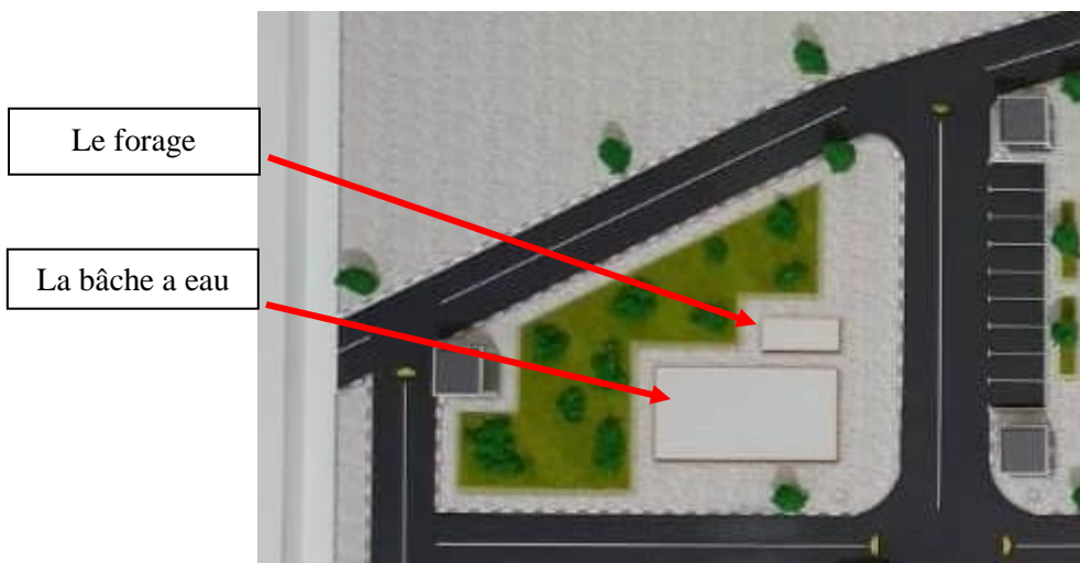
Figure 28 : l'emplacement du forage et de la bache a eau dans notre complexe.
