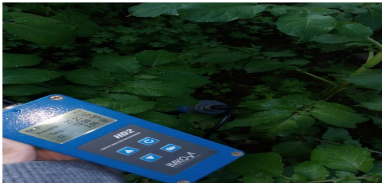
Figure 26: Suivi de l'état hydrique du sol par TDR.(Ouhemna et Boutareg 2022)
