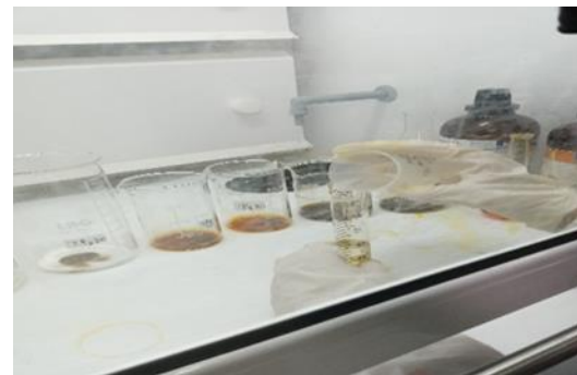
Figure 30 : Dosage de la matière organique.(Ouhemna et Boutareg 2022)
