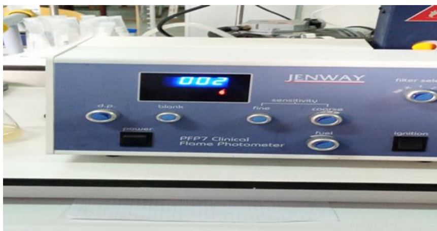
Figure 31 : Mesure de potassium et sodium par photomètre a flamme .
