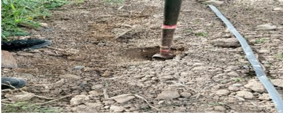
Figure 25: Prélèvement des échantillons Des sols à l'aide d'une tarière.(Ouhemna et Boutareg 2022)
