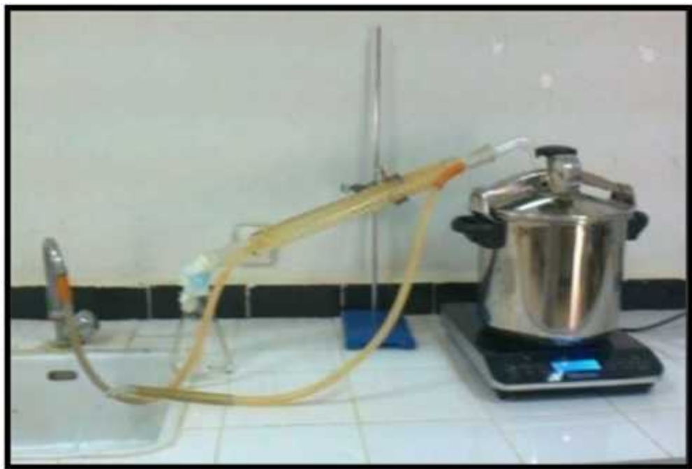
Figure 3.4. Montage de l'extraction assisté par induction électromagnétique.
