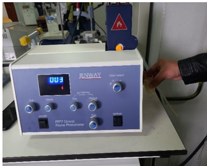
Figure 13 : Dosage de \text{K}^+ par spectrophotométrie d'émission de flammes (Semai et Hadouche 2022)
