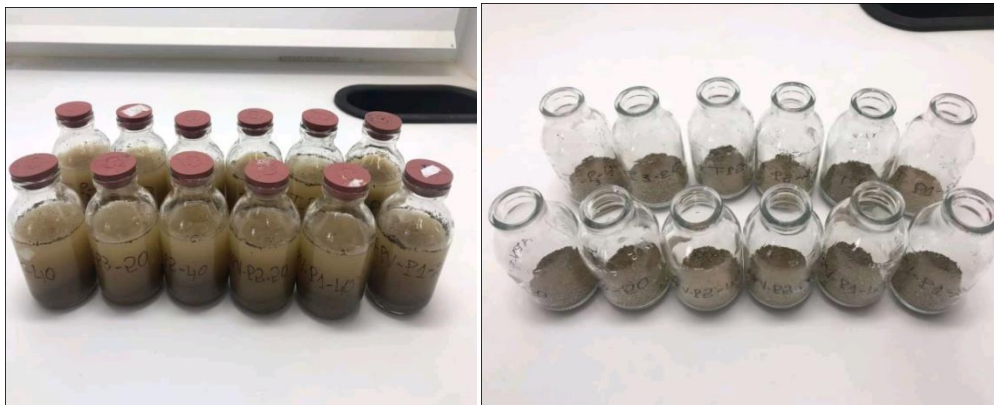
Figure26 : la solution de sol par l'eau distillée après séchage , pesée et tamissage
