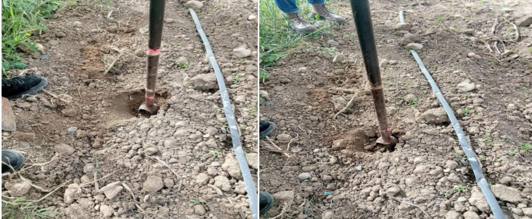
Figure25 :prélèvement des échantillons de sol avec tarière
