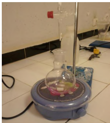
Fig. IV.8 : Dispositif de titrage pour définir l'indice d'acide.
