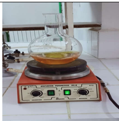
Figure 13: Préparation de la solution chlorure ferrique \text{FeCl}_3 à 2 %.(Original, 2022).
