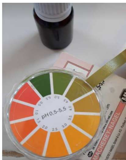
Figure 25 : Résultat de pH d'huile extraite à partir des graines d' Opuntia ficus indica sur papier indicateur de pH.
