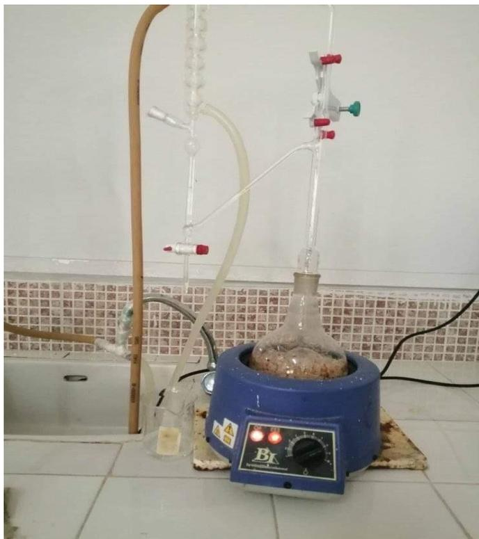
**Figure 12 :** Principe schématisé de l'hydrodistillation. (Touil.,2022).
