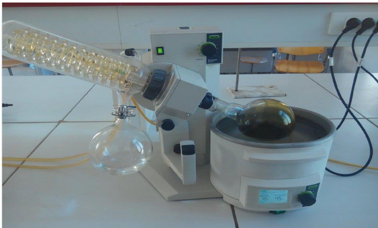
Figure 11 : Evaporation sous vide à 45°C (Bekheira, 2018).
