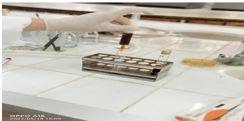
**Figure 13 : Filtration stérilisante par des micro-filtres (Original., 2022)**
