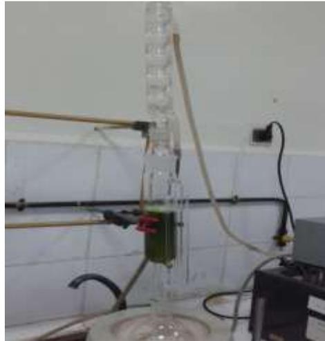
**Figure 19.** Schéma de l'extraction par Soxhlet (originale, 2022)
