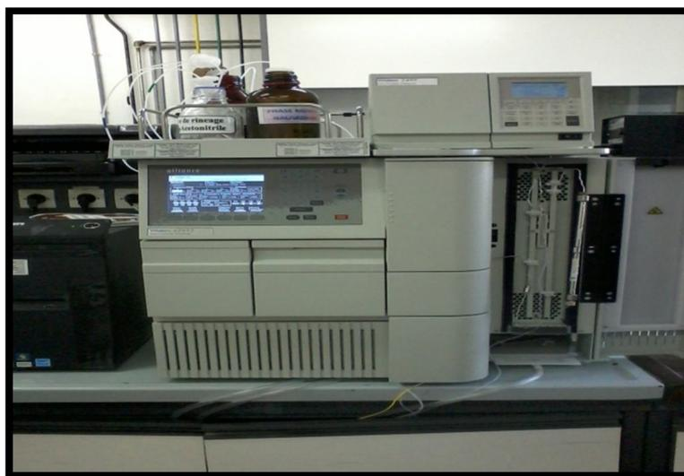
Figure 2.3. Appareil d'HPLC utilisé.
