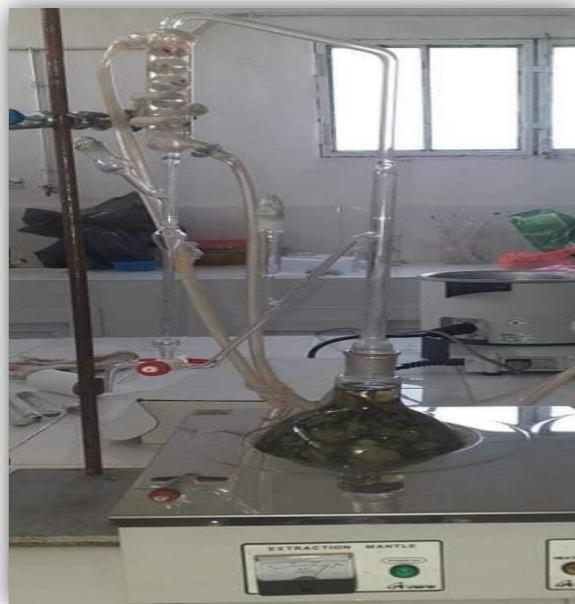
**Figure16 : Montage d'hydrodistillation de type Clevenger**
