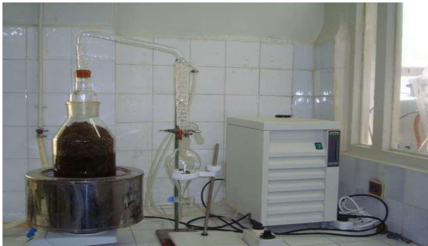
Figure4. Montage d'extraction par la technique d'hydrodistillation (Atmani-Merabet, 2018)
