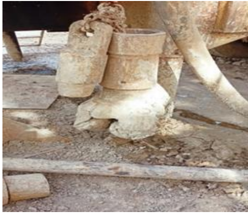
Figure II-6 : outil de forage 12''1/4 (photo prise sur le chantier.
