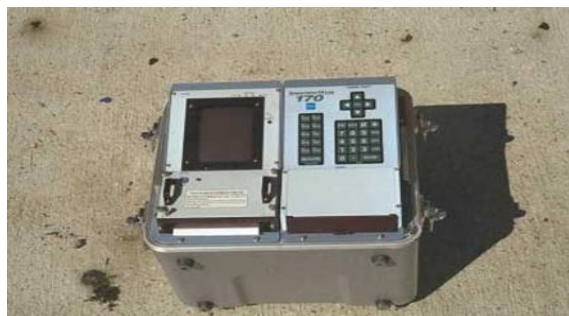
Figure II-10 : Système d'acquisition de l'équipement OYO.
