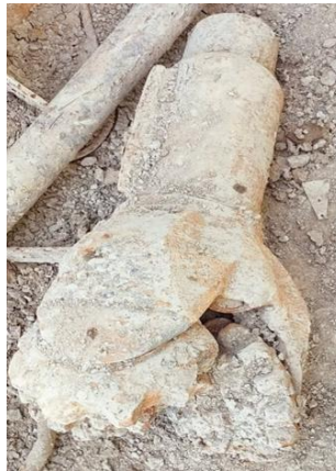
Figure II-12 : outil de forage 17'' 1/2 (photo pris sur le chantier).
