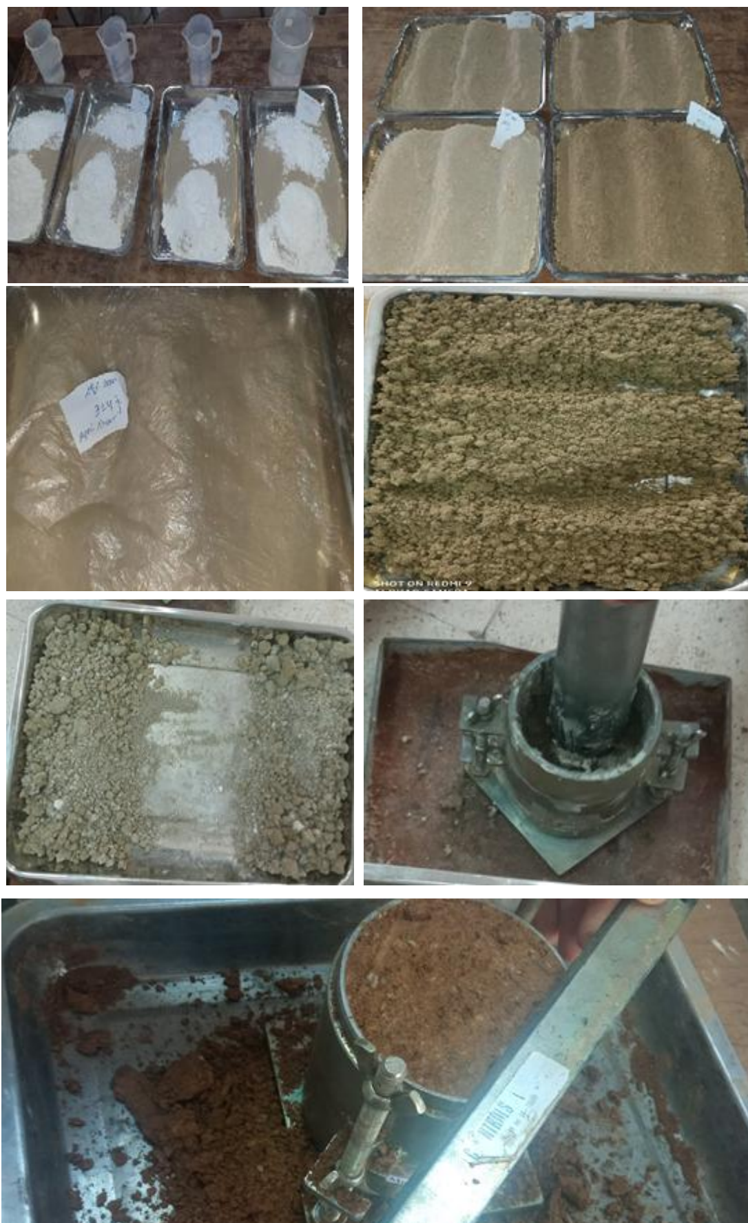
Figure 3.9- Préparation de la prise d'essai de compactage.
