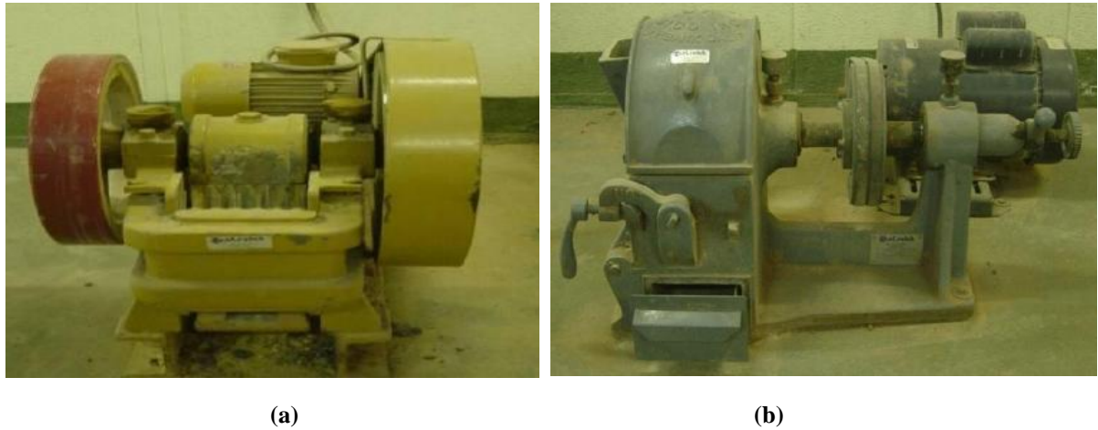
Figure 3.2- Moyens utilisés pour la préparation des sols, (a) : concasseur, (b) : broyeur. (Harichane et al, 2011a).
