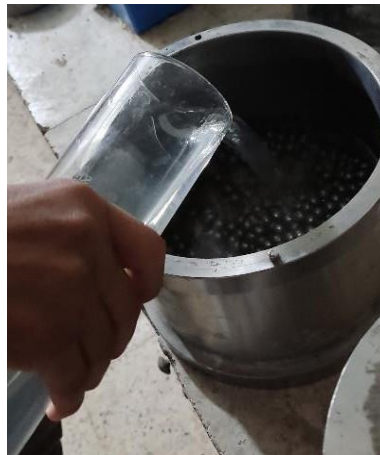
2. Mettre les boulets dans l'acier et verser 2.5 L d'eau
