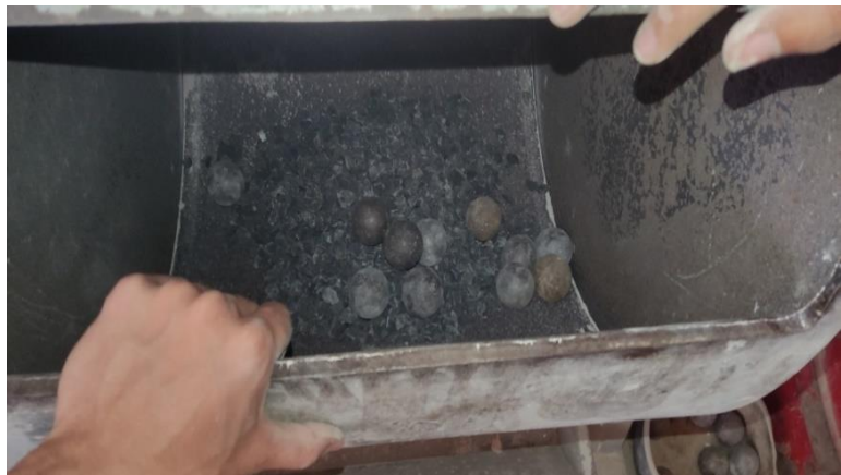
2. Placer l'échantillon dans le tambour avec 11 boules d'acier
