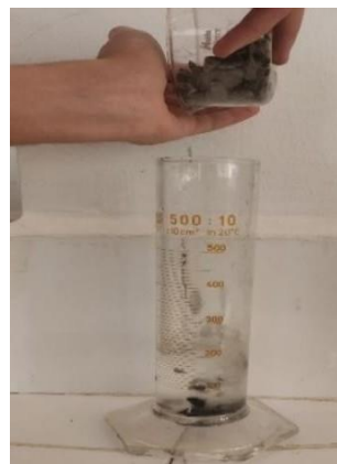
3. Verser l'échantillon dans l'éprouvette
