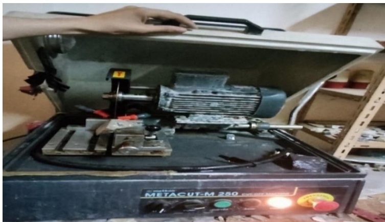
Figure IV.3. L'appareille de sciage utilisé pour la préparation d'éprouvette
