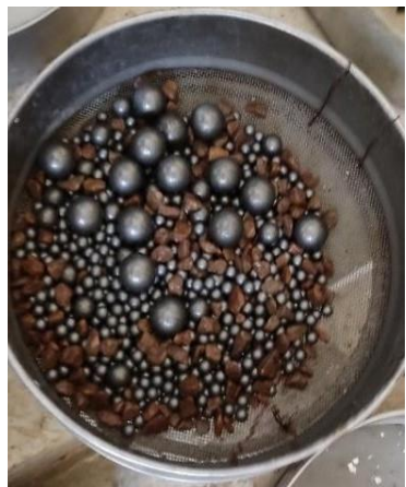
4. Forme des granulats après 2 h d'essai (Tamisât et refus sur le tamis de 1.6 mm)
