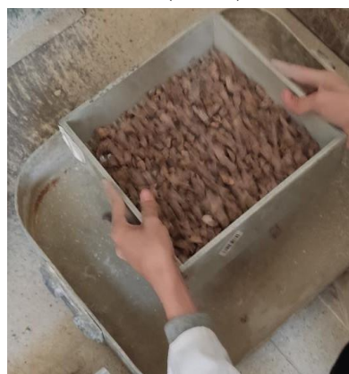
b- Tamiser le matériau sur la grille.
