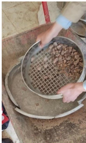
2. Tamiser matériaux concassés dans les tamis (10 à 14) mm.
