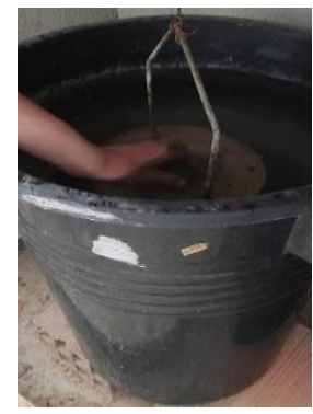
4. Placer l'échantillon sur le panier
