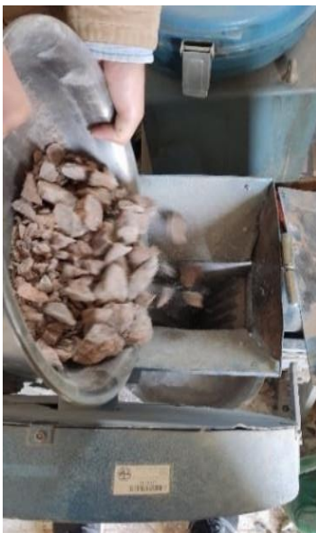
1. Mettre des petits morceaux dans le concasseur.
