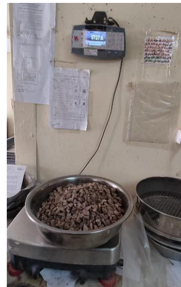
3. Peser les granulats jusqu'à l'obtention du poids requis
