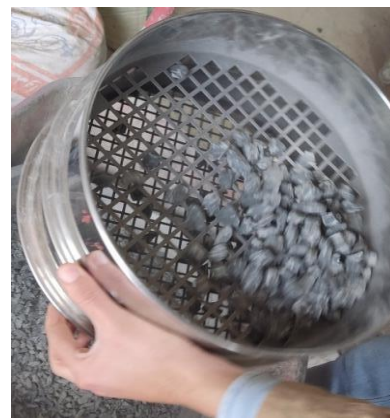
a- Tamiser le matériau sur les tamis (8 à 14) mm.
