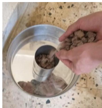
2. Verser les granulats dans le récipient
