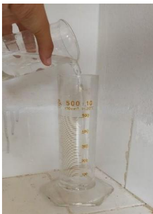
1. Verser 200 ml d'eau V1 dans l'éprouvette
