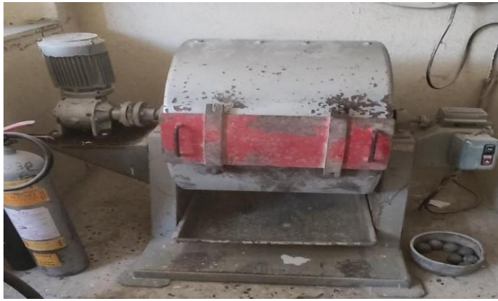
La machine Los Angeles avec le bac métalliques au-dessous et les boules de charge abrasive.
