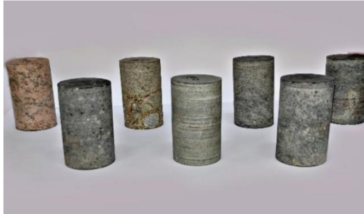
Figure IV.4. Eprouvettes cylindriques résultant du carottage et du sciage.
