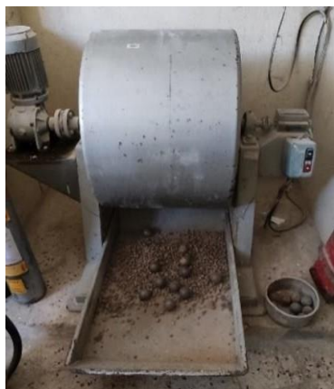
3. Collecter les granulats dans le bac métallique
