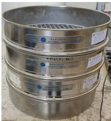
a- Tamiser le matériau sur les tamis (8 à 14) mm.
