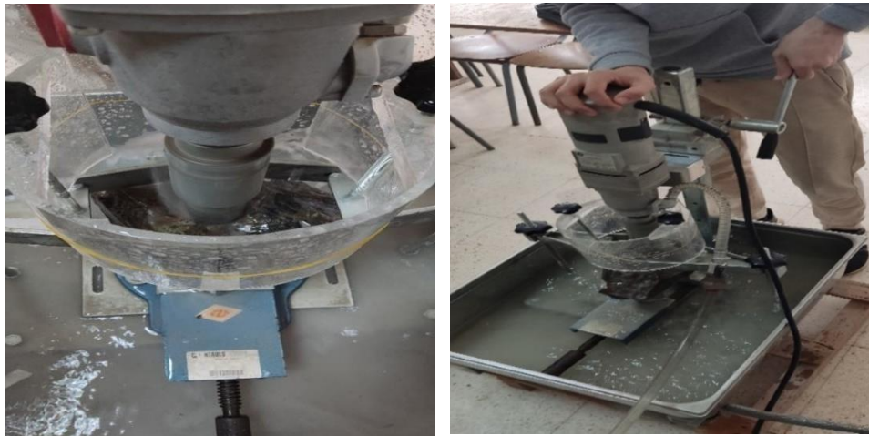
Figure IV.2. La carotteuse utilisée pour forer la roche avec injection d'eau.
