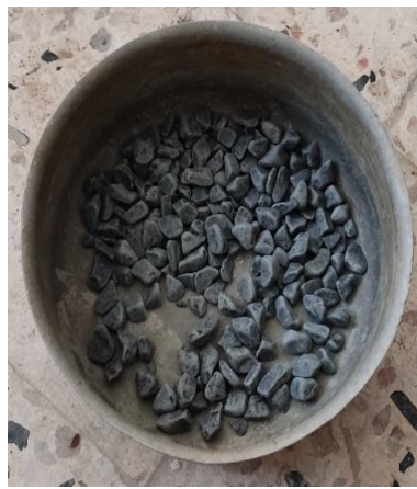
Séparer les granulats depuis les boulets et peser le refus « m' » de basalte et de rhyolite.
