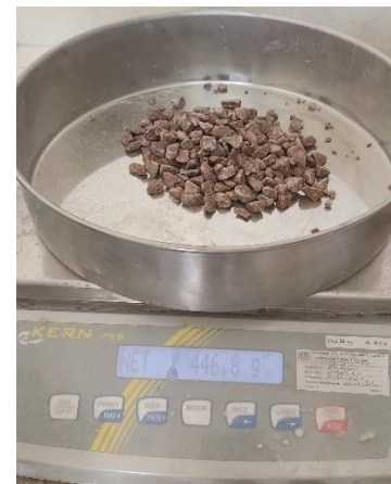
Séparer les granulats depuis les boulets et peser le refus « m' » de basalte et de rhyolite.
