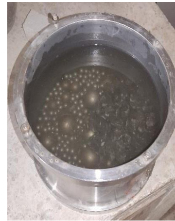
3. Mélange 500g ± 2g du granulat avec les boulets et l'eau
