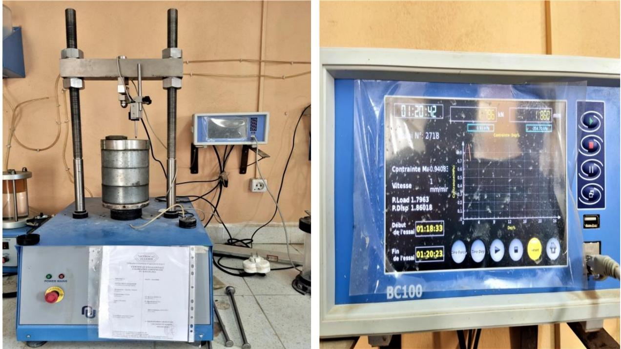
Fig III.9 :L'appareil pour UCS
