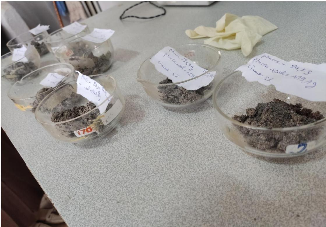
**Résultats des l'essai CBR Immédiat avec (0% .0.2% .0.5% .0.8%) de fibre**
