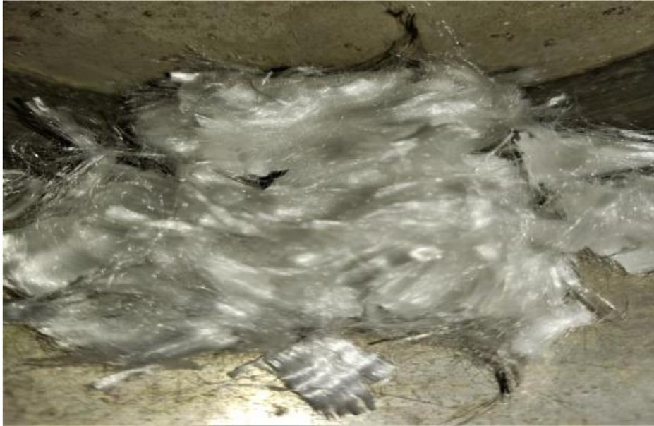
**Fig III.3:** Fibre de polypropylène utilisée dans les essais.
