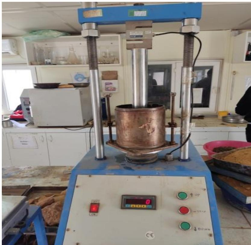
Fig III.6 : appareil de mesure CBR
