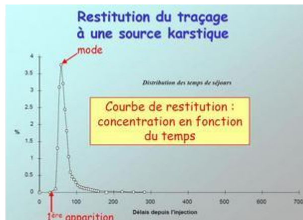
Figure I-11 Un exemple de courbe de restitution après injection d'un traceur.
