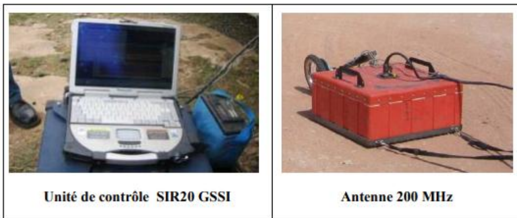
FigureIII-13 : Composition du matériel GPR GSSI utilisé.
