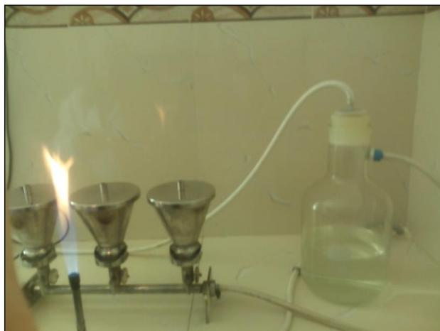
**Figure : Rampe de filtration**
