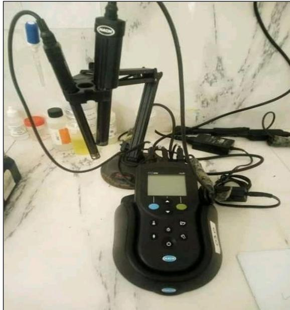
**Figure n° 11 : Appareil de multi-paramètres (pH, Température, Conductivité)**
