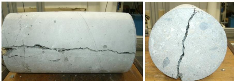
Figure 1.10. Rupture d'une éprouvette du béton sous forme de fendage.
