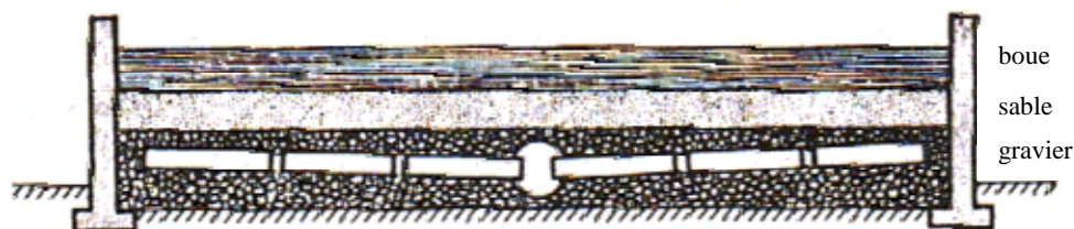
Figure 42 : Lit de séchage. (Ministère de l'intérieur et de l'environnement, 1990)
