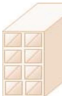
**Figure II.2** Brique creuse
