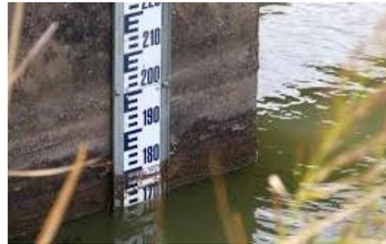
Fig. V-2 : Echelle limnimétrique verticale (l'EPMP, 2018)
