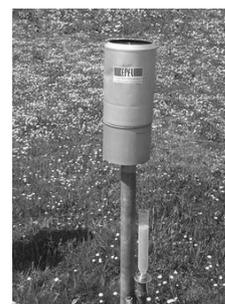
Fig. IV-5 : pluviomètre «éprouvette non incorporée» (Musy, 2005)
