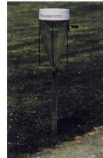
Fig. IV-4 : Pluviomètre à lecture direct « éprouvette incorporée » (Rieul, 2003)
