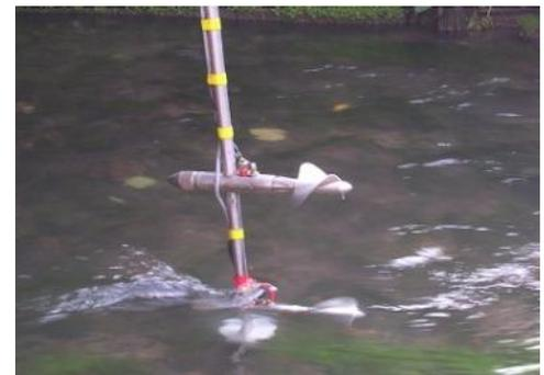
Fig. V-10 : Jaugeage au moulinet (Eaufrance, 2018)
