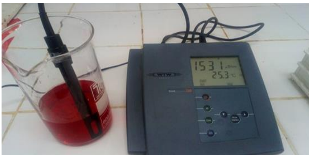
Figure IV- 20 : mesure de la conductivité électrique de rejet réel
