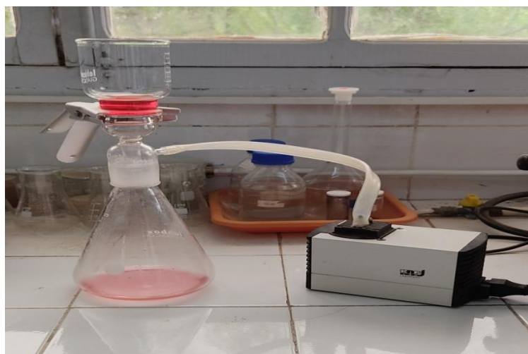
Figure III-8 : Montage à filtration des MES
