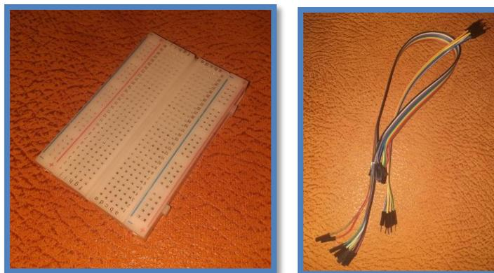
Figure 4. 19 Plaque d'essai et les straps de notre robot SA3
