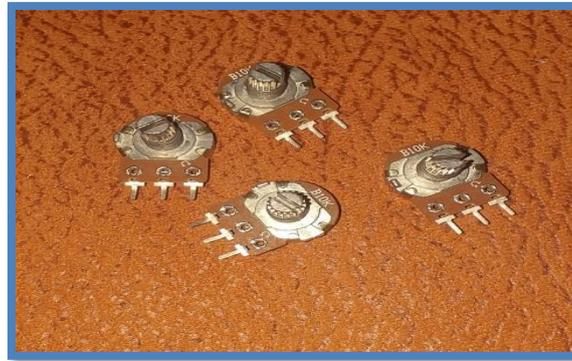
Figure 4. 18 Les 4 potentiomètres du robot SA3
