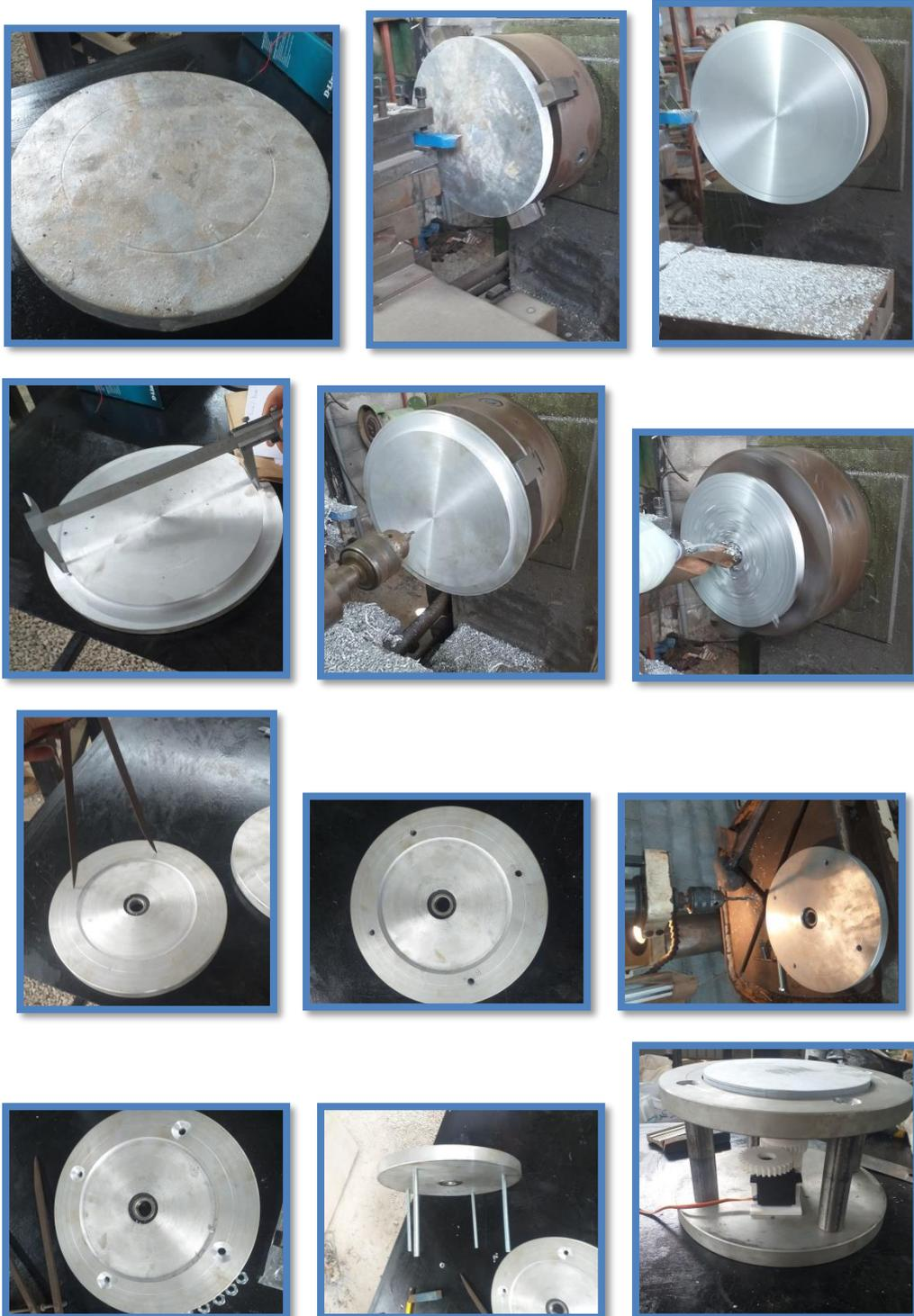
**Figure 4. 25** Quelques opérations durant l'usinage de la base du robot
