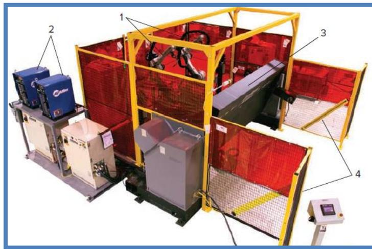
**Figure 1. 25** Un système de soudage à l'arc robotisé (1- Robot avec soudure à l'arc 2- alimentation pour le soudage 3-Positionneur 4- Protection 5- Extraction des fumées)[35]
