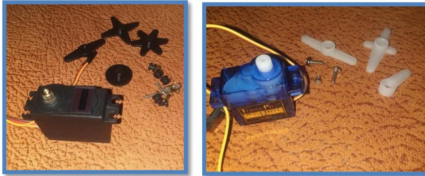
**Figure 4. 17** Les deux servomoteurs utilisés comme actionneurs
