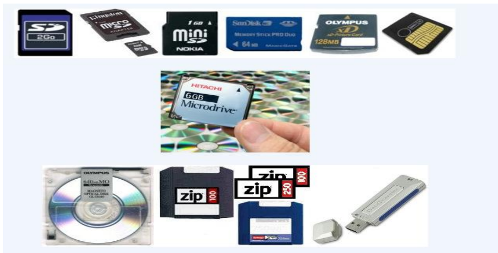
Figure I.8 : Types des mémoires de masse.
