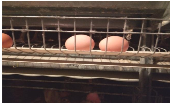
Photo N°15 : Tapis automatique pour ramassage des œufs (photo personnelle).
