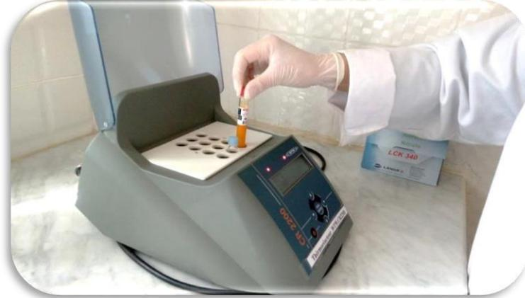
**Figure n°11 :** Teste de la DCO (Eau brute et épurée dans un thermoréacteur).
