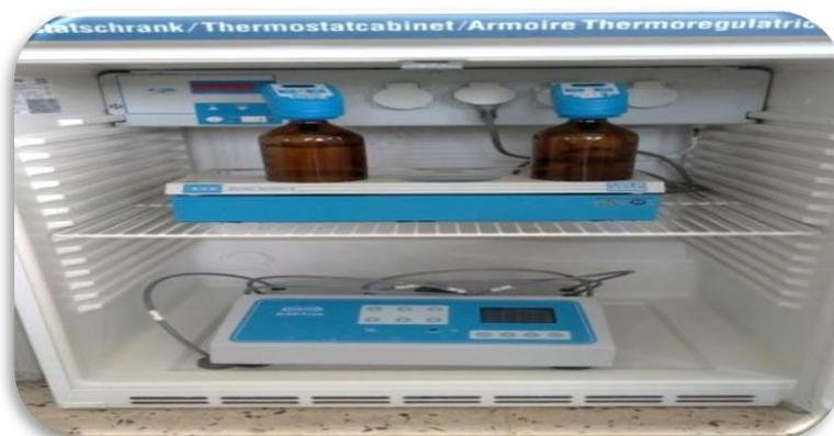
**Figure n°10** : Armoire régulatrice pour la DBO mètre.
