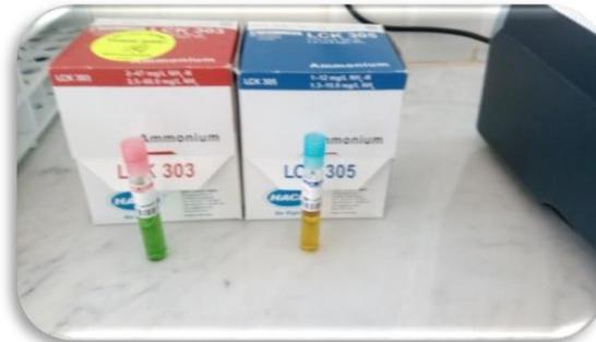
**Figure n°14 :** Teste en cuve de l'ammonium.
