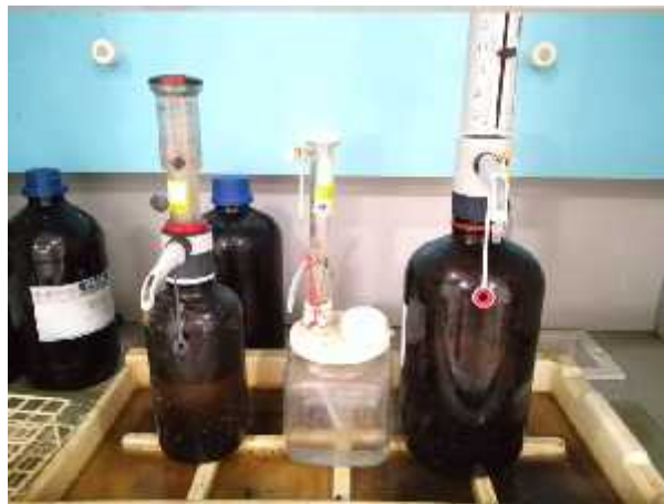
Figure18 : Mesure de la matière grasse par la méthode acido-butyrométrique.
