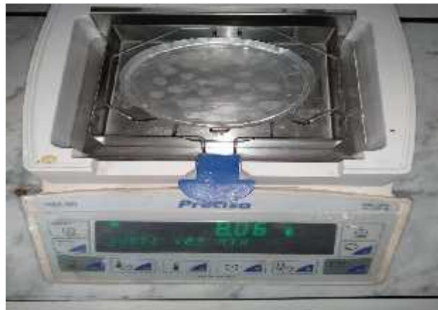
Figure17 :Mesure d'extrait sec totale par le dessiccateur.
