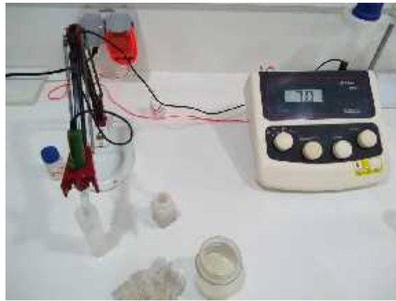
Figure15 : Mesure de pH par pH mètre.
