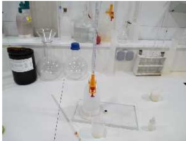
Figure16 : Mesure de l'acidité titrable par la méthode titrimétrique.
