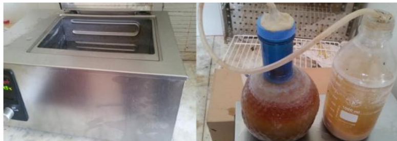
Figure III.6 : Le bain-marie et le réacteur de fermentation [45].
