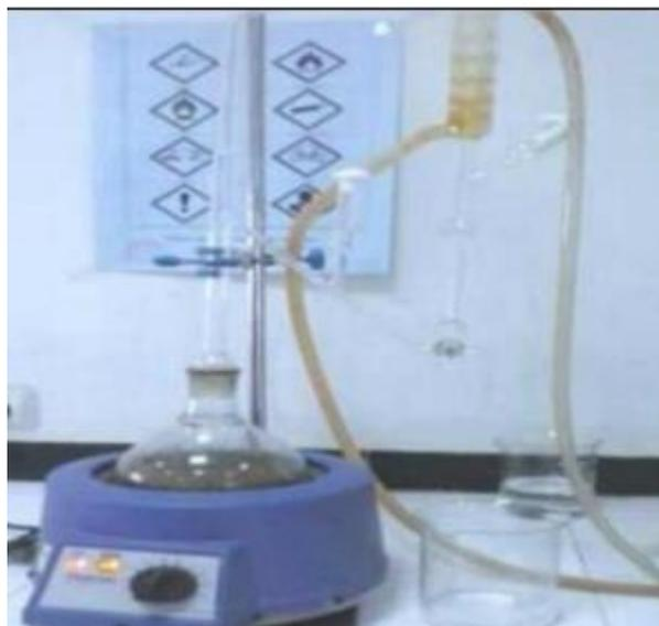
**Figure 7:** Appareillage d'hydrodistillation[Meghazi, 2012].
