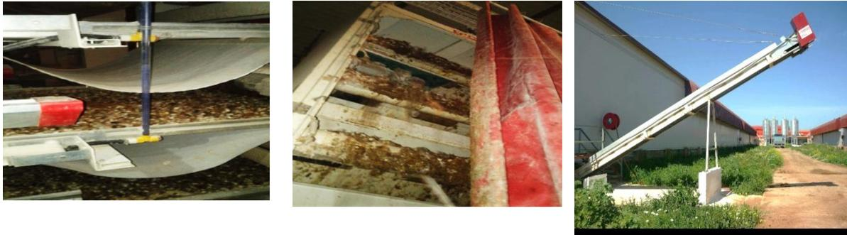
**Figure06** : les photos représente système d'évacuation des fientes
