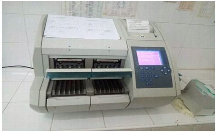
Figure 10 : automate MINI VIDAS® de laboratoire (BIOMERIEUX, FRANCE).
