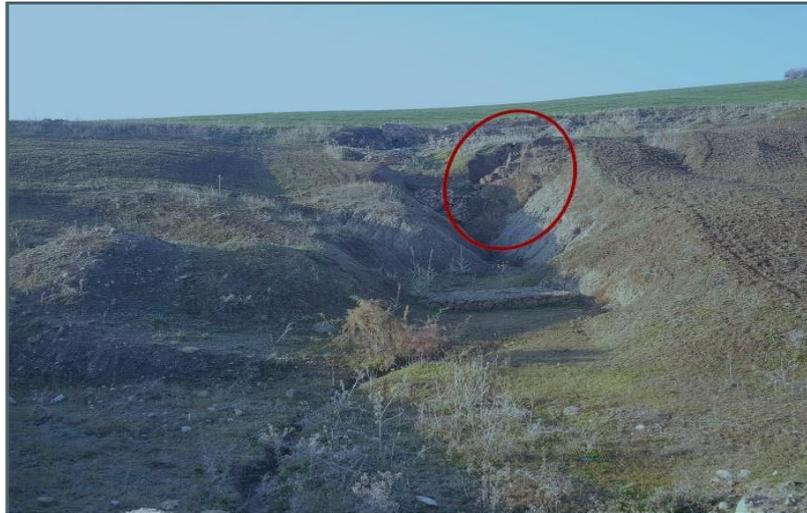
**Figure 2.21:** Aperçu sur un glissement de surface coté amont de la route [28].
