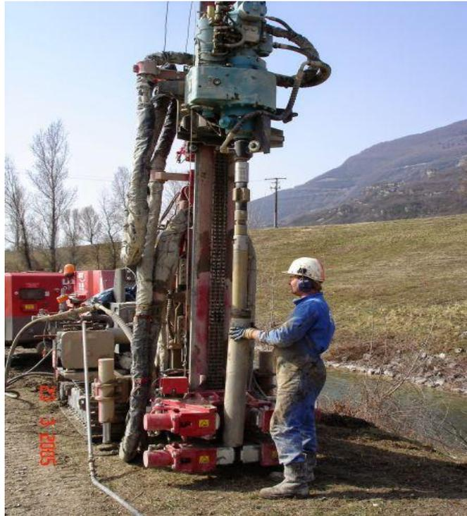
**Figure 3.2:** Schéma d'un essai de sondage carotté [40].
