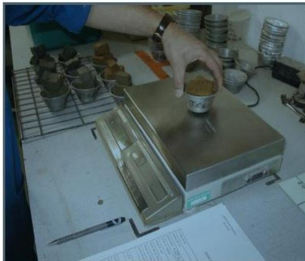
**Figure 3.7:** Mesure de la teneur en eau [38].
