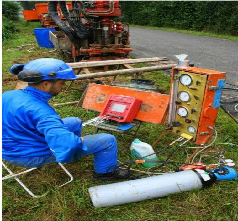
Figure 3.6: Représentation d'un pressiomètre Menard [41].
