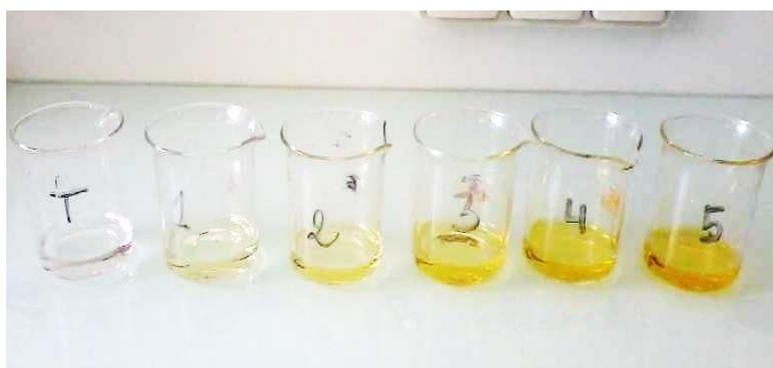
**Figure 04 : gamme d'étalonnage des nitrates.(12/09/2020)**
