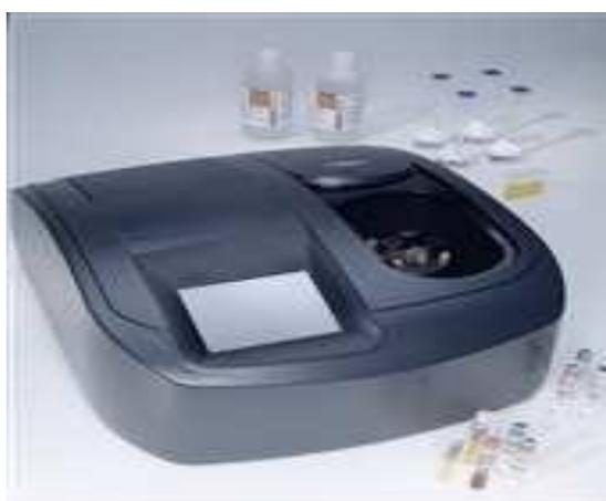
Figure 2: spectrophotomètre DR 6000
