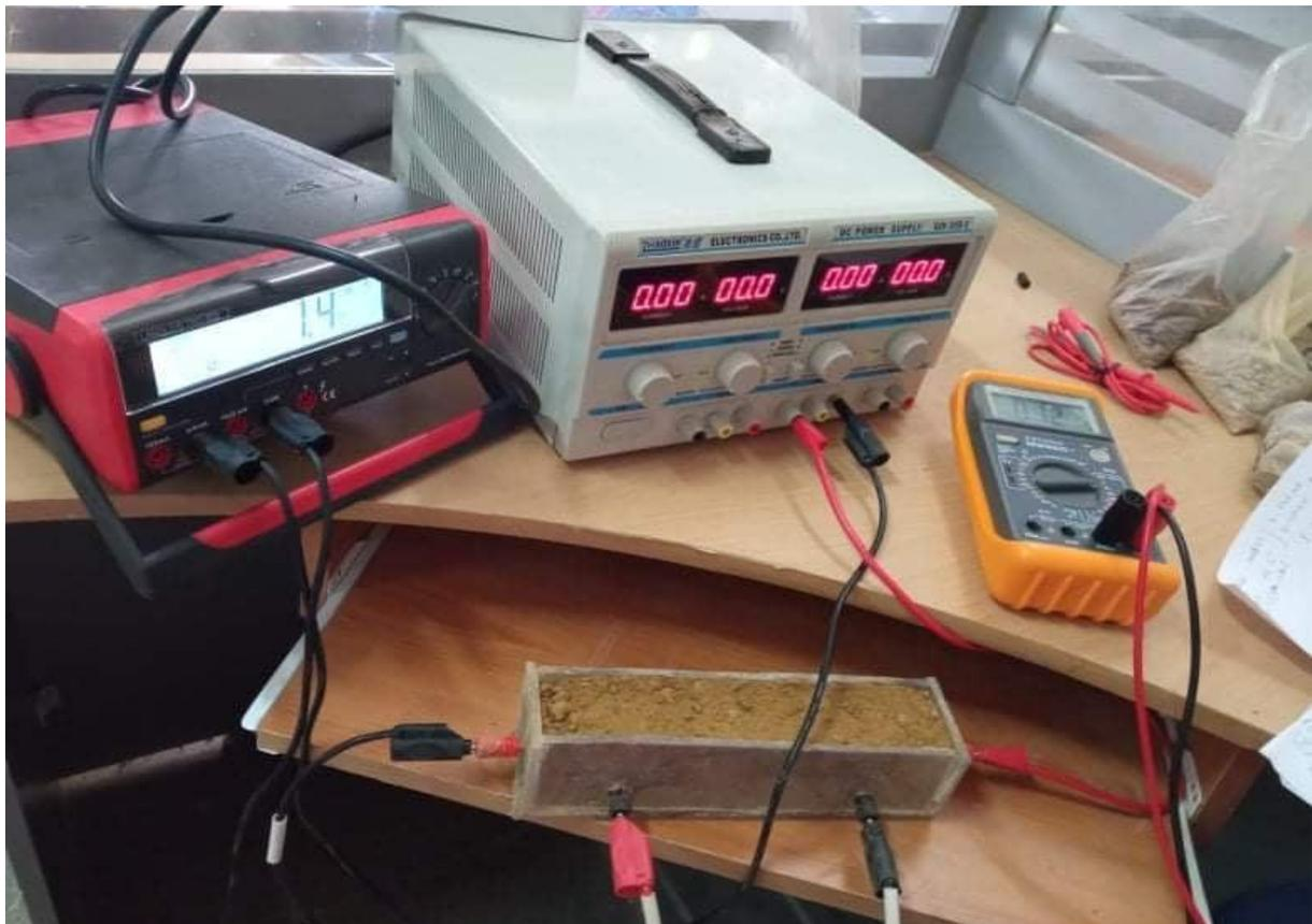
**Figure16** : Configuration de la mesure de résistivité
