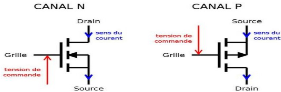
Figure II-17 : Symbole d'un MOSFET canal N et P.
