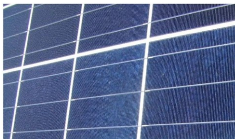
Figure I-15 : Module de silicium polycristallin.
