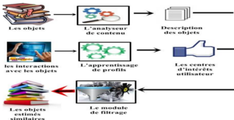
FIGURE 1.2 – Systèmes de recommandation basés sur le contenu[Rahila, 2015].
