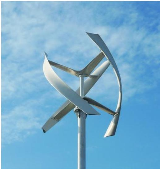
**Figure1. 16 Eoliennes à axe vertical**
