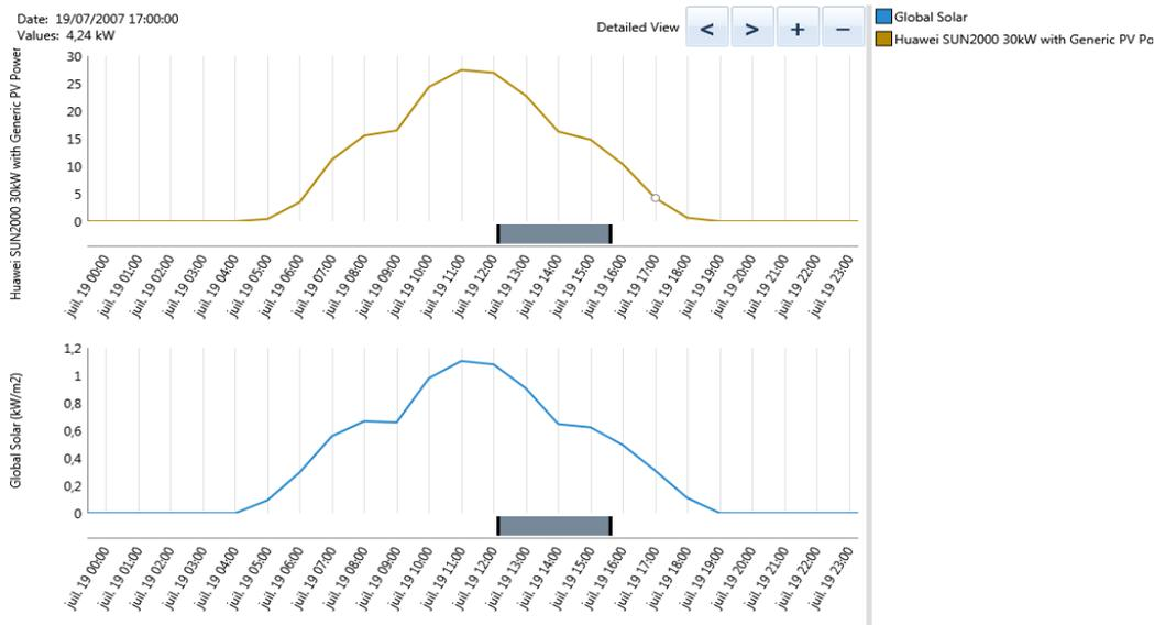
Figure1. 23 Résultat de la simulation du système en 19 juil. L'éclaircement et la puissance de sortie (PV)
