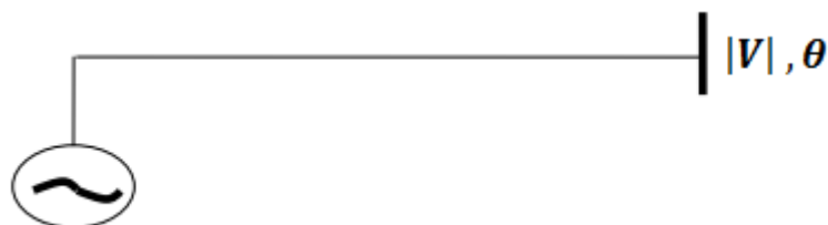
Figure I.7 : Modèle d'un générateur utilisé dans l'étude de l'écoulement de puissance
