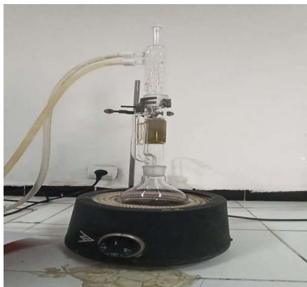
Figure II.3. Procédé d'extraction par Soxhlet
