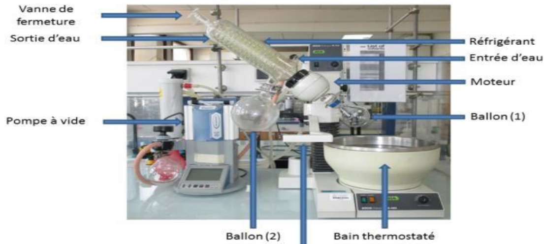
Figure .1. Schéma détaillé de l'évaporateur rotatif [60]
