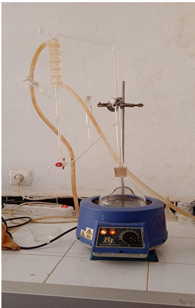
**Fig.IV.2** : Montage d'hydrodistillation.
