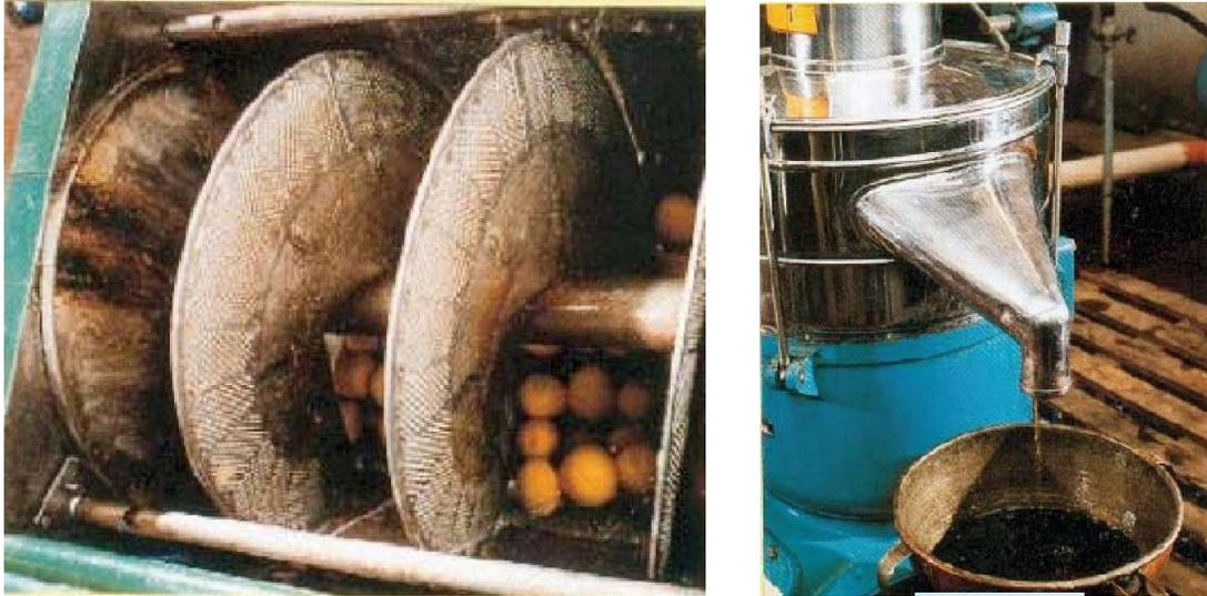
**Fig.III.4** : Photos à gauche d'une Pelatrice et à droite d'une centrifugeuse séparatrice de l'HE de citrus des eaux résiduelles [31].
