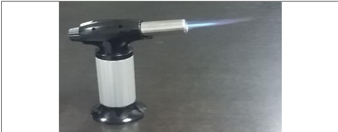
Fig. IV.1 : Flamme pour une ouverture de la vanne au minimum
