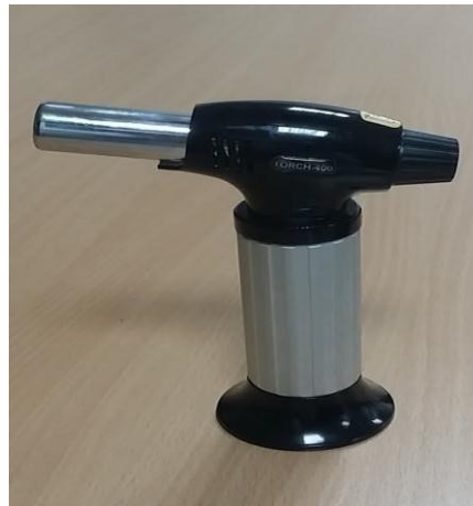
Fig. III.2.1 : Brûleur à gaz manuel de cuisine avec flamme réglable
