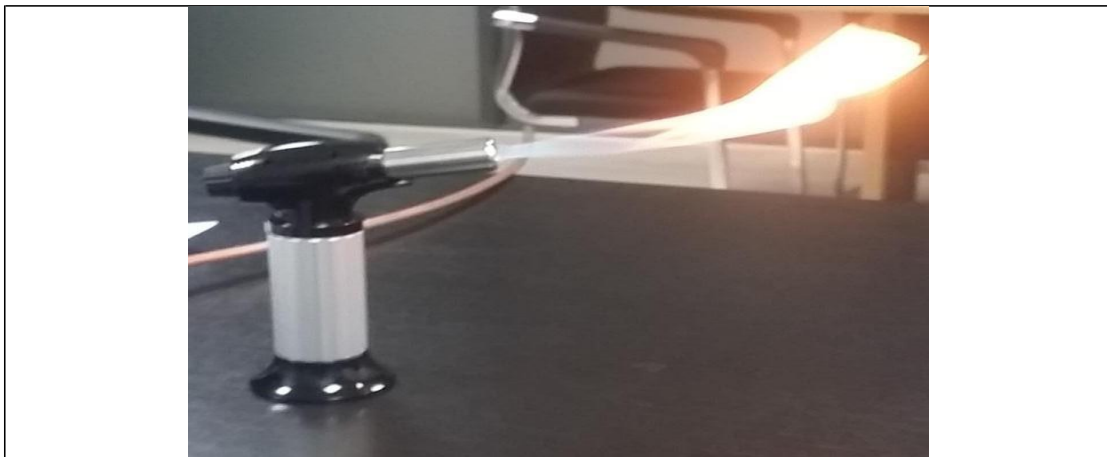
Fig. IV.2 : Flamme pour une ouverture de la vanne à moitié
