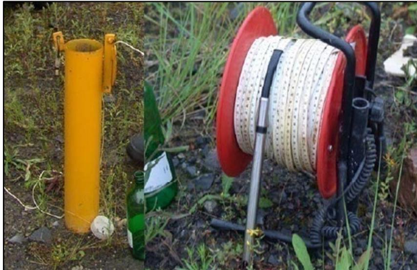
**Figure II. 6 :** Piézomètre et sonde à interface (Vidal, 2010)
