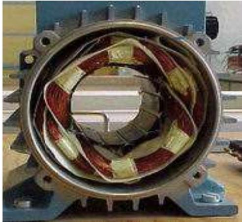
Figure III.2 Stator du moteur asynchrone [45]
