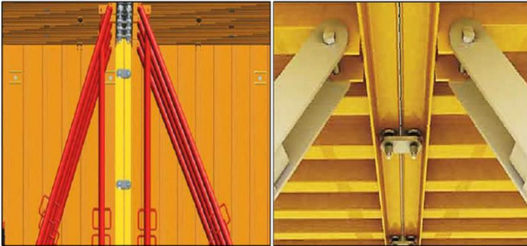
Figure I.12. Solidarisation les deux demi coquilles.
