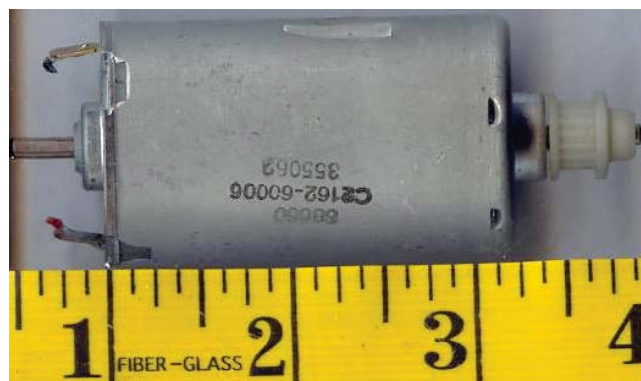
FIGURE 3.34 – Moteur-DC :C2162-6006 HP / Mabuchi Small DC moteur avec pignon
